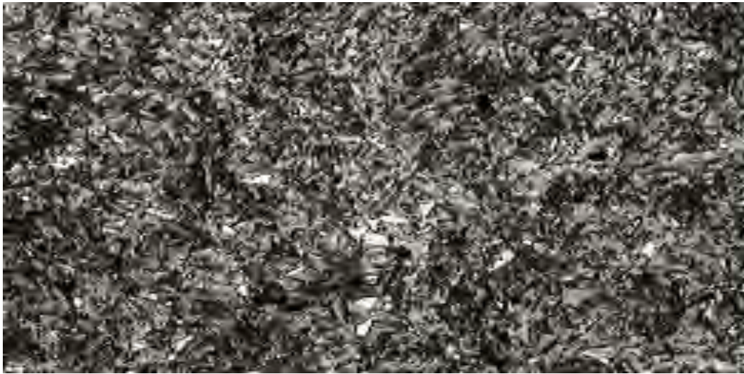
Şək. 2. B40X poladının tablamadan sonrakı özəyinin mikrostrukturu: x400
