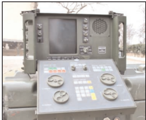
ŞƏKİL 4. GÖRÜNTÜ CİHAZI VASİTƏSİLƏ NƏZARƏT – ərazidə aşkar olunmuş hədəflərin ölçülərini, koordinatlarını, hərəkət istiqamətlərini, sürətini, tipini müəyyənləşdirmək və ekranda izləmək olur.
