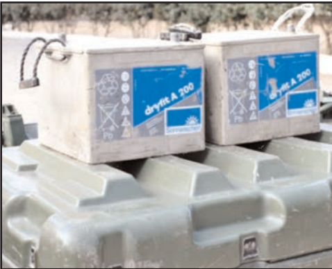
ŞƏKİL 5. AKKUMULYATOR BATAREYALARI – AC girişində gərginlik kəsilən zamanlarda “Askarad” a lazım olan gərginliyin aramış ötürülməsini təmin edir.
