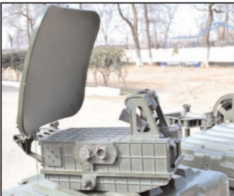
ŞƏKİL 3. DALĞAÖTÜRMƏ VƏ QƏBUL ETMƏ CİHAZI – bunun vasitəsilə mikrodalğaların ötürülməsi və hədəfdən əks olunan dalğaların qəbulu həyata keçirilir.
