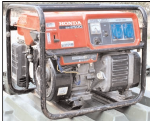
ŞƏKİL 8. GENERATOR – Elektrik şəbəkəsi olmayan yerlərdə cərəyan verilməsi üçün istifadə olunur.
