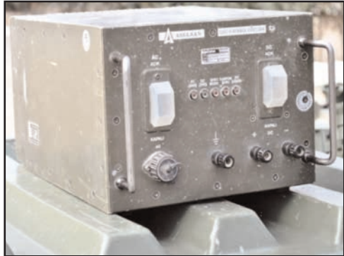
ŞƏKİL 4. GÜC MƏNBƏYİ – “Askarad” a lazım olan gərginliyin (24 V) verilməsi və batareyaların doldurulması üçün nəzərdə tutulub.
