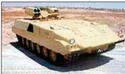
“Tariq” tankı (İordaniya) bazasında yaradılmış ağır ZTR (PDM) “Timsah”
