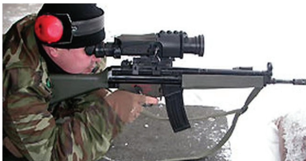
Şək.2. Silah üzərində gecəgörmə cihazı
