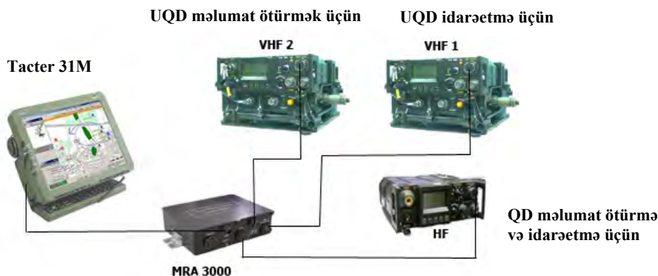
Şək. 2. Aw@reNet İdarəetmə sisteminin tərkibi və quruluşu
