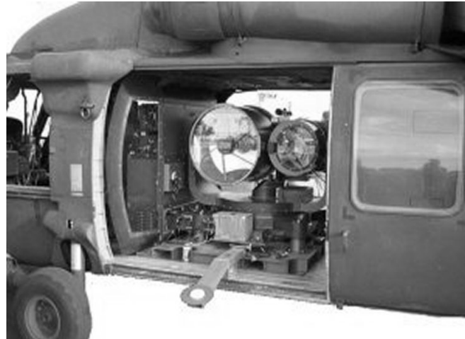
Şək. 2. Bioloji silahın uzaq təsir radiuslu aşkaredilmə sistemi (LR-BSDS)
