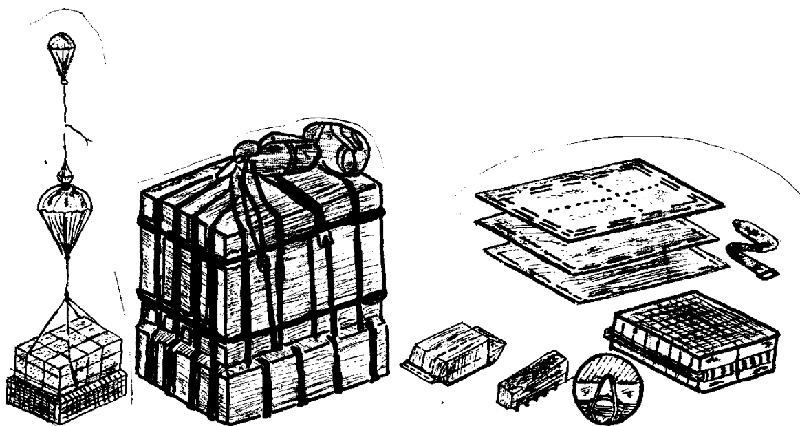
Рис.3. Парашютно-грузовая система ПГС-500 и её составные части.
