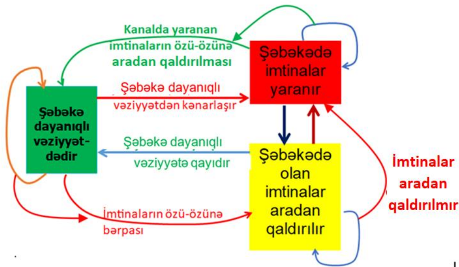
Şəkil 3. Marşrutizatorun vəziyyət-keçid-vəziyyət modeli
