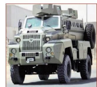
"İldirim" zirehli maşınıdır. MRAP sinfinə aid olan altı silindrilı maşın 265 at gücündə mühərrikə, mexaniki transmissiya və havalandırma sistemi ilə təchiz edilib. Zirehli maşının uzunluğu 7350 mm, boş halda çəkisi 13 ton, döyük çəkisi 15,5 ton, sürəti saatda 90 kilometrdir. Zirehli maşının yan hissələrində iki ədəd, arxa hissəsində mexaniki olaraq açılıb-bağlanan qapı, qüllə his-
