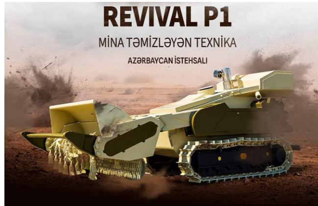
Şəkil 2. Revival P1 minatəmizləmə qurğusu
