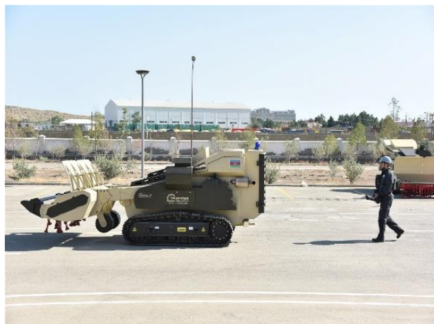
Şəkil 1. Revival M tipli özüyəriyən minatəmizləmə qurğusu
