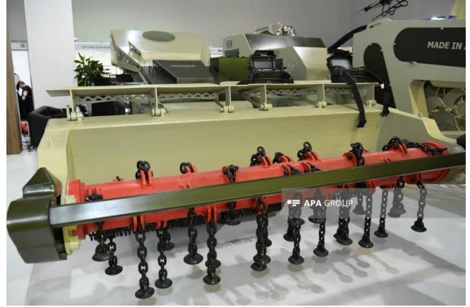
Şəkil 4. “Revival M” minatəmizləmə qurğusunda döyücləmə toxmaqları
