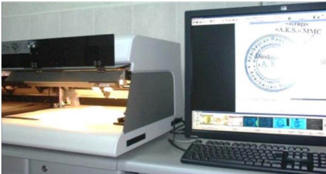
Şəkil 20. “Foster+Freeman” şirkətinin istehsalı olan “VSC 6000/HS” video-spektral komparatorun görünüşü
