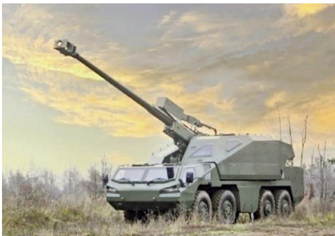
Excalibur şirkəti tərəfinən hazırlanmış 155 mm-lik DITA haubitsa sistemi DANA M2-nin növbəti təkmülüdür.
