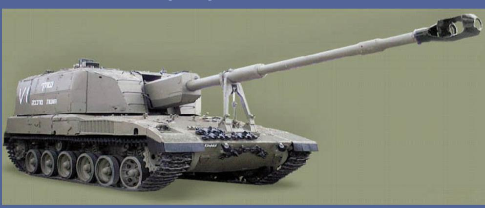
155 mm-lik özüyeriyən "Slammer" haubitsası İsrailin Silahlı Qüvvələri üçün hazırlanıb və 1990-ci ildə nümayiş etdirilib. Haubitsa "Merkava" tankının şassisi üzərində quraşdırılır və 155 mm-lik qülləni təsvir edir. Haubitsanın tam şəkildə 360 dərəcə dönen polad qülləsi İsrailin "Zoltam Cuc-temz"
