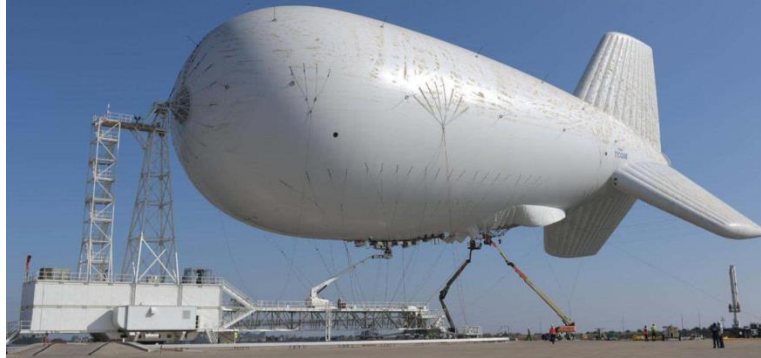
Şək. 9. VHF diapazonlu dairəvi görünüşün RLS ilə təchiz edilmiş aerostat. İsrail
