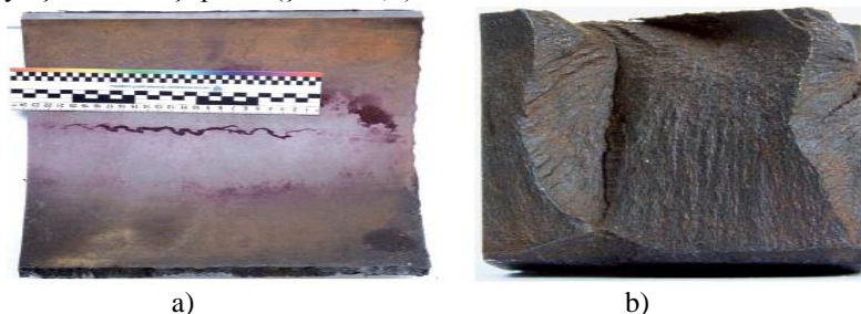
Şəkil 7. Ø 457x20,62 mm xam qazın borusunun metalının gərginlik altında korroziya çatlaması
