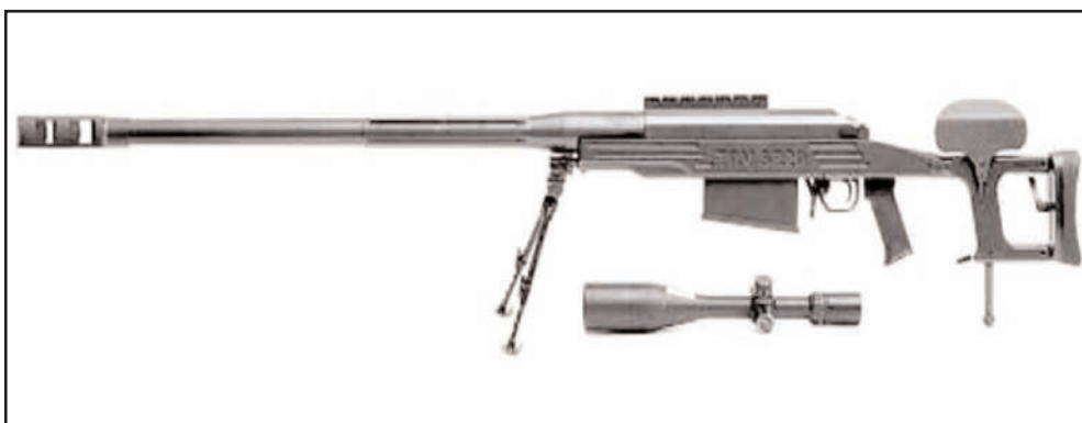
ŞƏKİL 9. 20 x 82 mm-lik İRİÇAPLI SNAYPER TUFƏNGİ “TRUVELO SR”
