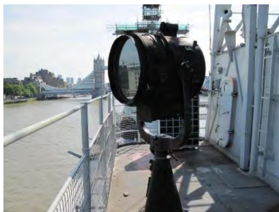
Şəkil 1. Gəmilərdə quraşdırılan MCHII 250W/24V tipli siqnal projektoru
