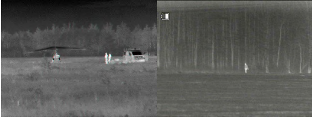
Şəkil 3. İstilikgörmə cihazı ilə obyektin aşkar edilməsi
