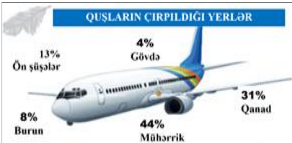
Şəkil 3. Təyyarənin müxtəlif hissələrinin quşlarla toqquşma və zədələnmələri
