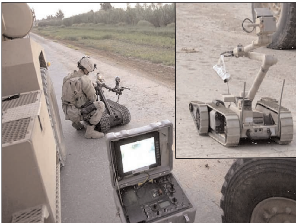
ŞƏKİL 7. ABŞ ordusu tərəfindən İraqda istifadə edilən "iRobot Packbot" tipli istehkamçı-robot
