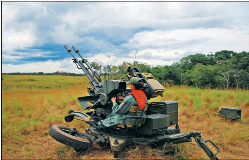
Şəkil 4. Optik-elektron vasitələrlə (OEV), ballistik hesablayıcı və yönəlmənin elektrik gətiriciləri ilə təchiz edilmiş təkmilləşdirilmiş ZQ-23-2 zenit qurğusu
