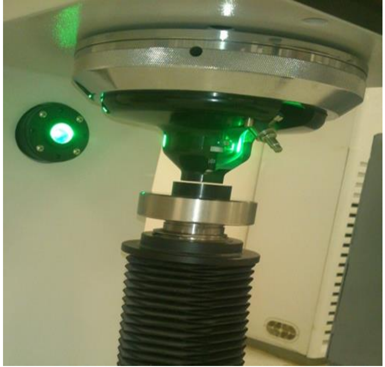
Şəkil 2. Innovatest seriyalı Nexus 7501 markalı cihazda mikrobərkiyin ölçülməsi
