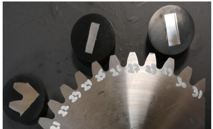
Şəkil 3. Padaqlanmış dişlərin səth keyfiyyətlərini tədqiq hissələrinin sxemi və mikrobərkiyin ölçülməsi üçün şiflər
