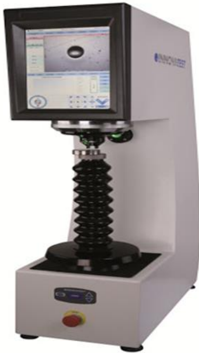
Şəkil 2. Innovatest seriyalı Nexus 7501 markalı cihazda mikrobərkiyin ölçülməsi
