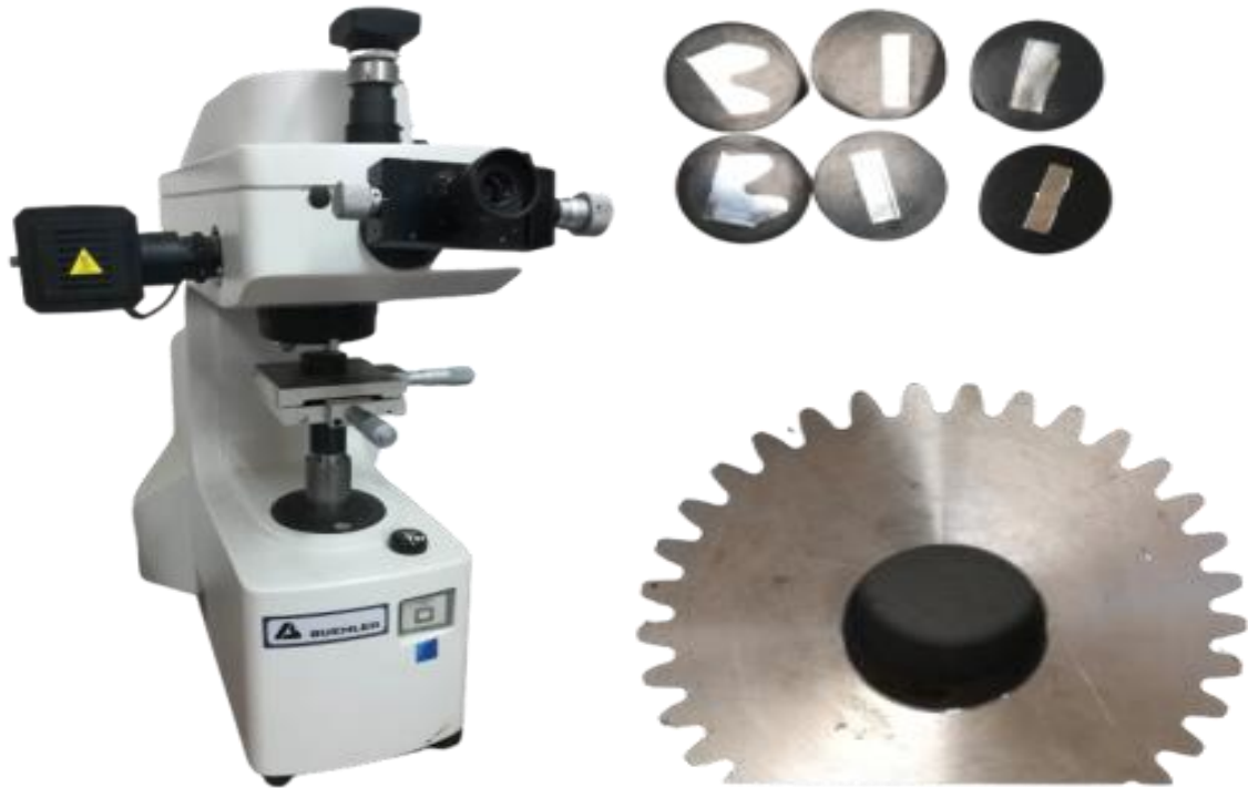
Şəkil 4. MicroMet 5101 markalı ölçü cihazında mikrobərqliyin ölçülməsi
