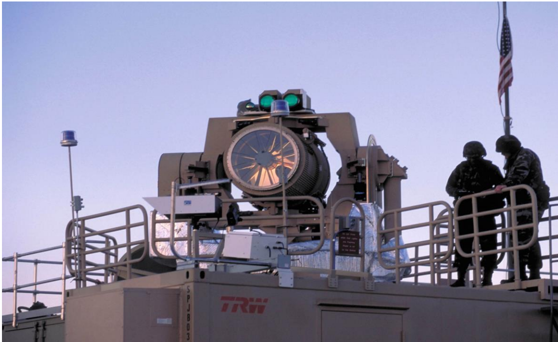
Şəkil 1. ABŞ-ın TRW şirkəti tərəfindən yaradılan THEL taktiki yüksək enerjili lazer silahı
