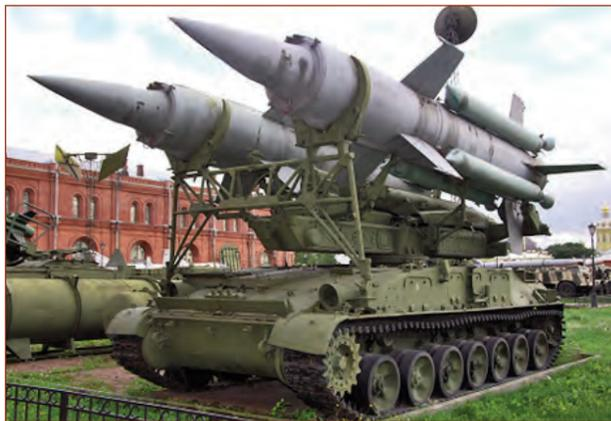
ibarətdir. Bu da kompleksə torpaq yolda daha yüksək sürətlə hərəkət etməyə imkan verir. Raketlərin tuşlanmasını yerinə yetirən radiolokasiya stansiyası zenit idarə olunan raketə radio-komanda üzrə idarəetməni təmin edir. Stansiya avtomatik olaraq hədəf-göstərici üzrə hədəfləri aşkaretmə stansiyasından gələn informasiyaları emal edir və hədəflərin tez bir vaxtda axtarışını yerinə yetirir.
