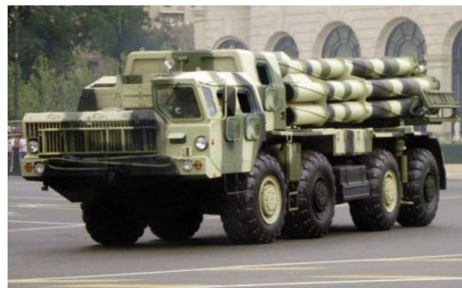
reakтив mərəmni daşıya bilir. Artilleriya hissəsi isə 12 ədəd boruşəkilli istiqamətləndiricidən, fırlanan gövdədən, qaldırıcı və dönmən mexanizmlərdən ibarətdir. Bundan başqa döyüş ma-
