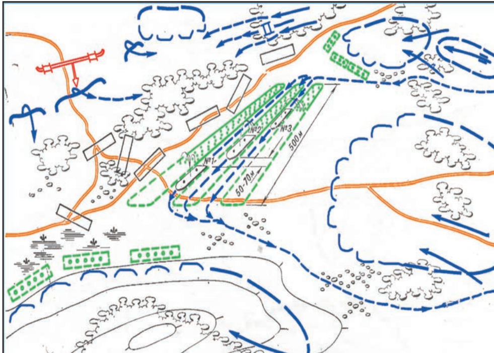
ŞƏKİL 4. ÜÇ ZOLAQLI MİNA SAHƏSİNİN ÜÇ ƏDƏD MİNADÖŞƏYƏN (UMZ) TƏRƏFİNDƏN QURULMASI VARIANTI
