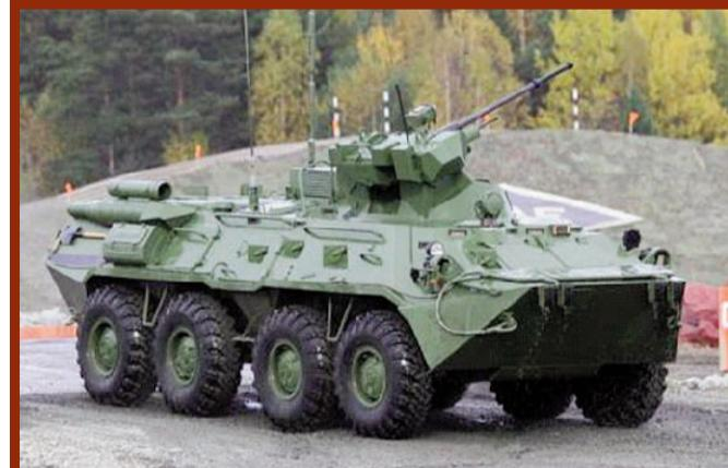
raşdırılan yeni müşahidə cihazları və nişangahlar effektiv olaraq hədəfləri aşkar və məhv etməyə imkan verir. "BTR-82A" transpotyorunda quraşdırılmış KamAZ-740.14-300 müasir mühərriki, çox enerjili amortizatoru, modernləşdirilmiş paylayıcı qutusu, kardan valı və va-hid şəklə salınmış bort ötürü-məxanizmləri maşının resursunu artırmağa, şassının davamlılı-ğını, hərəkətlilik xüsusi-yətlərini artırmağa imkan
