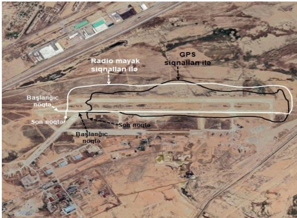
Şəkil 2. GPS siqnallarının itirilməsi və radio mayak siqnallarının qəbulu zamanı PUA-nın qalxma formaları
