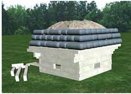
Şəkil 3. Beton dirəklərdən hazırlanmış bunker
