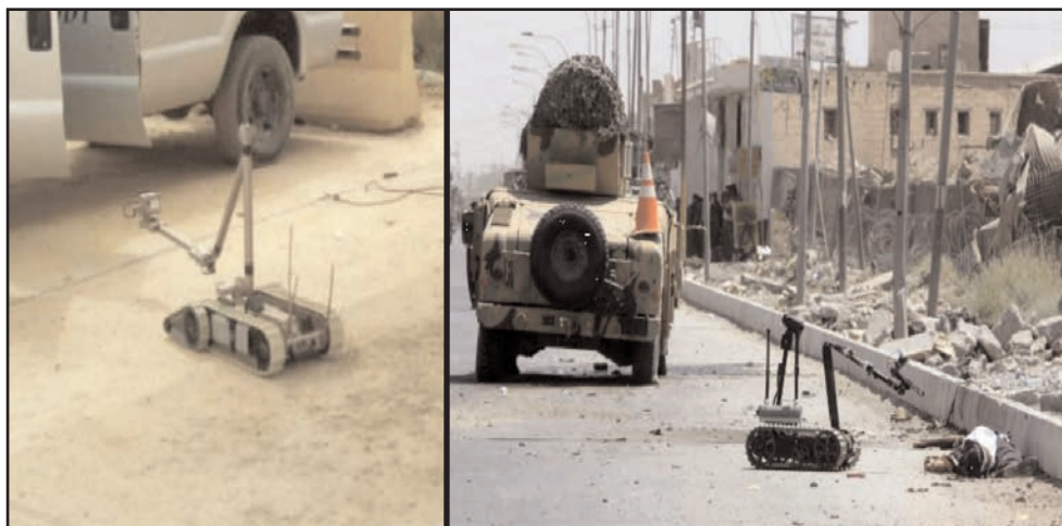
ŞƏKİL 4. "iRobotPackbot" TIPLİ ƏPQ-YƏ QARŞI MƏSAFƏDƏN İDARƏOLUNAN KƏŞFİYYAT VƏ ZƏRƏRSİZLƏŞDİRMƏ CİHAZI
