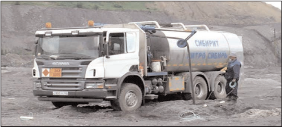
ŞƏKİL 2. QARIŞDIRICI-DOLDURUCU MAŞINLA (QDM) PARTLAYIŞ ÜÇÜN HAZIRLANAN ŞPURUN EPM-LƏ DOLDURULMASI [10]
